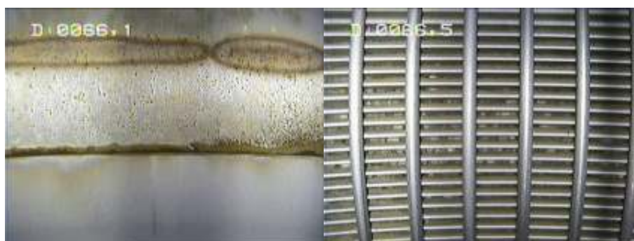
Figure 10 : 4 ème zone crépinée entre -66 et -67 m
